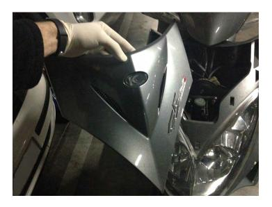
Una vez extraída esta tapa debemos quitar dos tuercas del 10 que sujetan faro y frontal al chasis, las veremos montadas en el soporte de la bocina. Son dos tuercas con sus dos arandelas.
