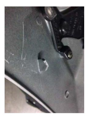
Para ello usad el destornillador plano, id haciendo palanca poco a poco con cuidado hasta liberar las pestañas. La tapa en teoría sale deslizándola hacia abajo dirección al faro, pero está realmente duro.
